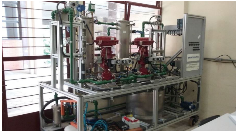
Figura 9 – Bancada didática para processos contínuos SMAR, compondo o laboratório de manufatura industrial
